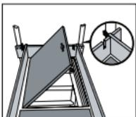
Eine Risikobeurteilung kann die Montage von Bordbrettern an der Belagbühne verlangen. Es dürfen keine Spalte vorhanden sein. Siehe Abschnitt „Montage der Bordbretter“
