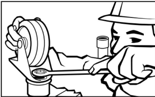
Anleitung im Fußspindel-Set beachten, um den großen Fahrrollenbolzen durch den kleineren im Set auszutauschen. Neue Fahrrolle nach Anleitung in eine Fußspindel einführen und dann Befestigungsschraube wieder mit dem Ringschlüssel festziehen. Diesen Schritt bei den anderen Fahrrollen und Fußspindeln wiederholen.
