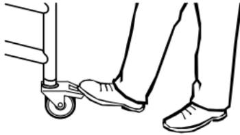
Prüfen, ob der Untergrund eben ist und alle vier Fahrrollen den Untergrund berühren. Mit Wasserwaage prüfen, ob Basis in Waage ist. Fußspindeln bei Bodenunebenheiten oder abschüssigem Boden montieren. Siehe Abschnitt „Montage der Fußspindeln“.
