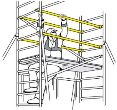
**16** Belagbühne mit Durchstieg auf die 14. Sprosse des Gerüsts versetzen (die oberste Sprosse des unteren Erweiterungsrahmens (8 Sprossen))
