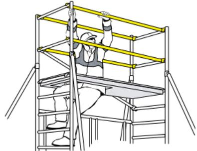
Wenn Längsriegel als Geländer montiert sind, sollten sie sich stets 0,5 m bzw. 1,0 m oberhalb der Plattformoberfläche befinden.
