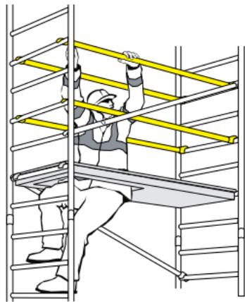
**11** 4 Längsriegel als Geländer auf der 2. und 4. Sprosse oberhalb der Plattform auf beiden Seiten des Gerüsts montieren. ERST DANN auf Plattform stellen, wenn die Geländer eingebaut sind.
